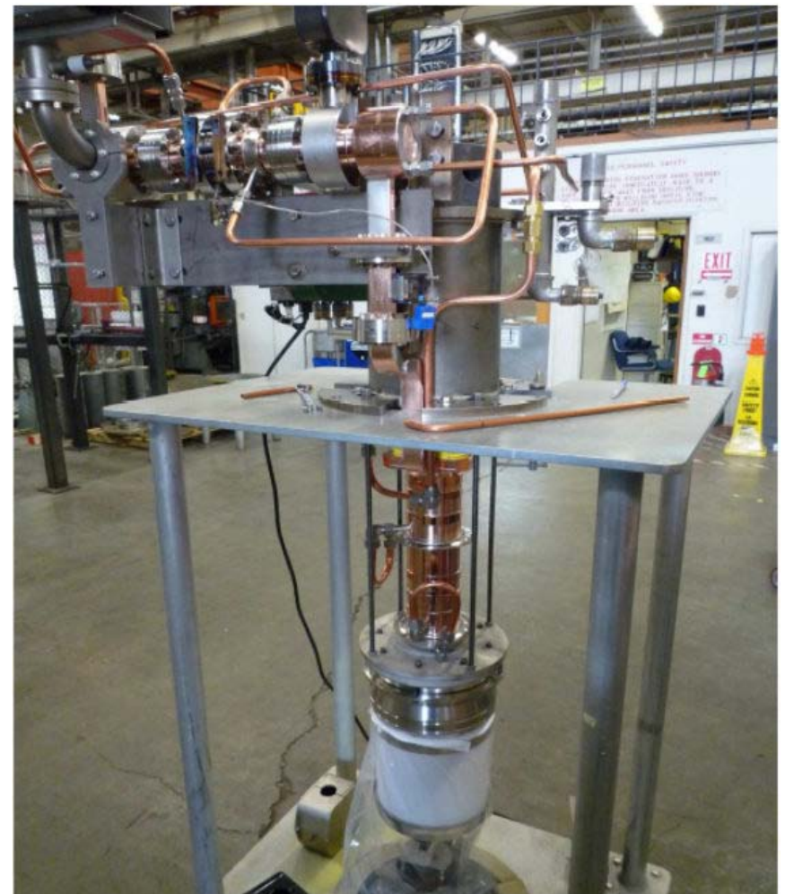
50 MW pulsed X-band klystron (SLAC XL5)
