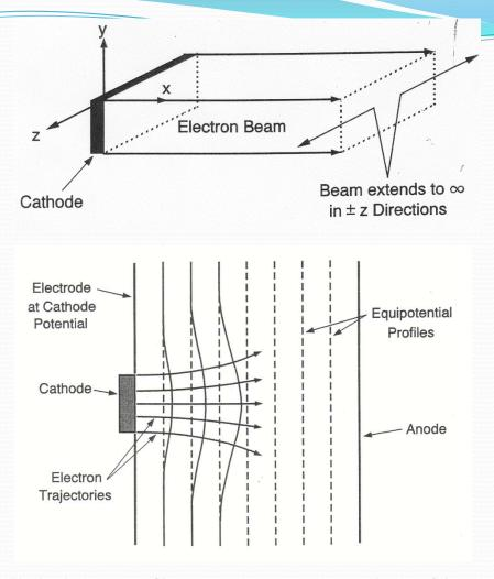
Parallel electron flow – Equipotential profiles
